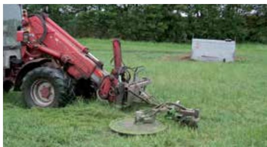
Særlig slåmaskine til brug under hegnstråd. Foto: Heidi M. Andersen
